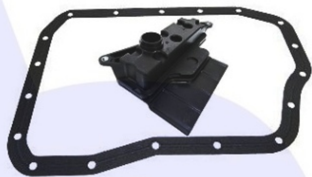
U660 Pan Gasket U660.GAS01 Filter U660.FIL01
